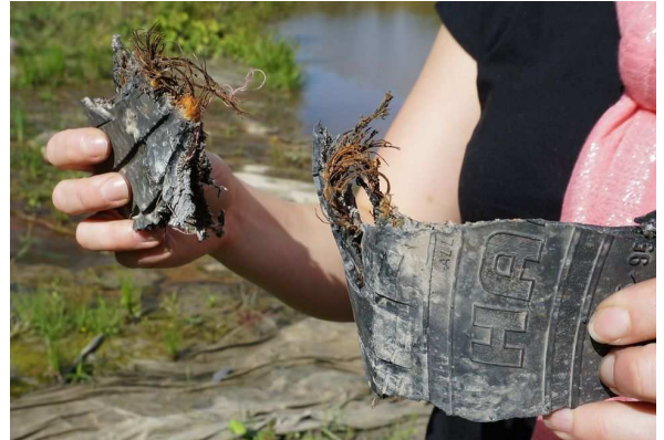
300mm rengasrouhe läpäisee hyvin vettä. Kuva: Suomen Rengaskierrätys Oy
